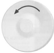
Повернуть тарелку вентиля из положения «щелчка» против часовой стрелки (по направлению к положению "открыто") примерно на пол-оборота.
