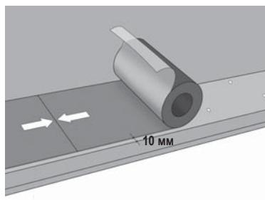
Далее на карнизную планку карнизного свеса приклеивается самоклеящаяся карнизная полоса Kerabit. Нижний край полосы укладывается примерно на 10 мм выше места сгиба планки. Снимите с полосы защитную пленку и прижмите ленту к планке. В местах соединения полосы монтируются плотно друг к другу.
