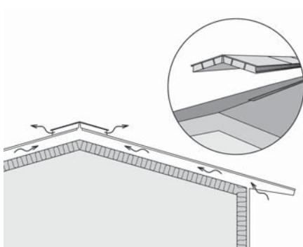
Перед монтажом необходимо убедиться в том, что основание достаточно вентилируется. Повысить эффективность вентиляции можно при помощи коньковых вентиляторов Kerabit, которые монтируются по всему коньку. См. специальную инструкцию по монтажу коньковых вентиляторов Kerabit.
