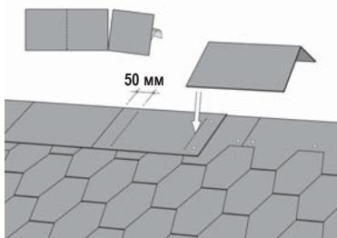
Конек монтируется из коньковых плиток Kerabit. Гвозди в верхнем ряду гонтов должны остаться под коньковыми плитками. Сгибанием отделяйте плитки для конька (3 штуки) друг от друга. Защитную пленку снять, плитку для конька согнуть и прижать на место. Закрепить четырьмя гвоздями по краю так, чтобы гвозди остались под следующей плиткой для конька (нахлест плиток для конька должен составлять около 50 мм). Последнюю плитку закрепить только битумным kleem, не прибивать.
