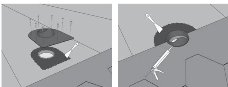
Сквозной проход устраивается при помощи подходящих уплотнений следующим образом: приклейте по всей площади фланец уплотнения сквозного прохода к подкладочному ковру не меньше, чем на расстоянии 150 мм. Закрепить края фланца саморезами или гвоздями. Вырезать в битумных гонтах по месту сквозного прохода отверстие соответствующей формы и размера. Приклейте гонты к фланцу и нижнему гонту битумным клеем минимум на 150 мм. В завершение обработайте сквозной проход битумным клеем.
